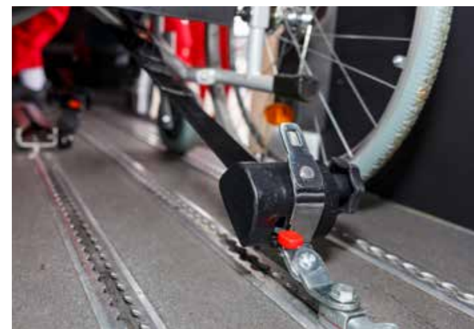
Im Boden des Kleinbusses ist ein Schienensystem installiert, an dem der Rollstuhl während der Fahrt befestigt wird.
